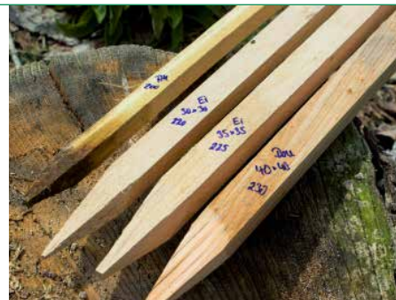
Abb. 11: Bewährt haben sich Haltestäbe mit Längen ab 2,3 m sowie einem Durchmesser von 40 mm x 40 mm. Eiche und Lärche halten bis heute problemlos, Douglasienholz ist bei Bodenkontakt nicht zu empfehlen.
