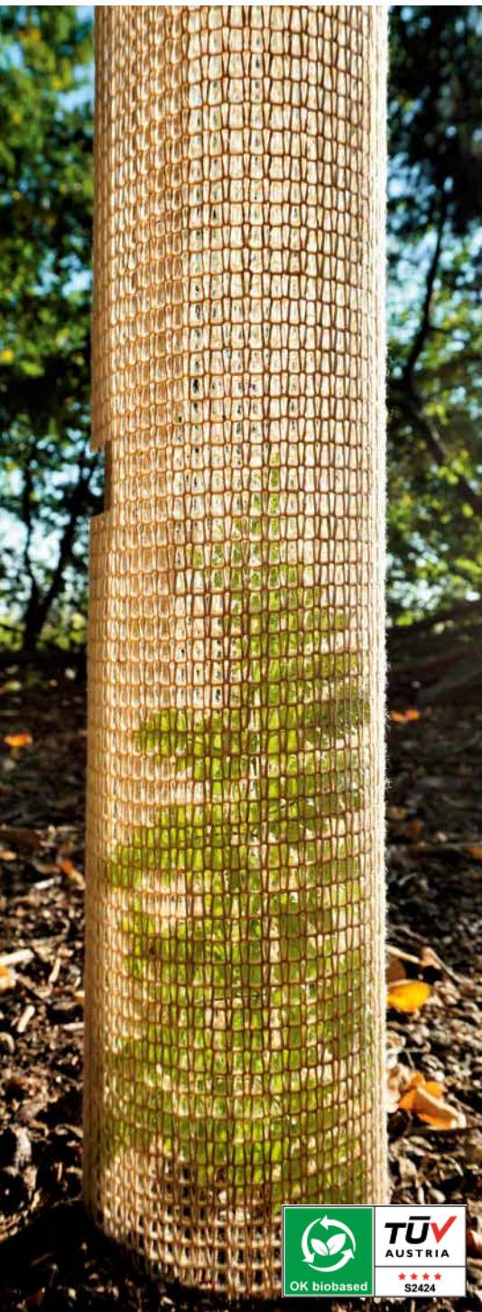
Abb. 10: Kurz nach der Montage standen einige Testprodukte schräg. Das Problem waren aber nicht die Hüllen, sondern zu kurze und zu schwache Haltestäbe.
